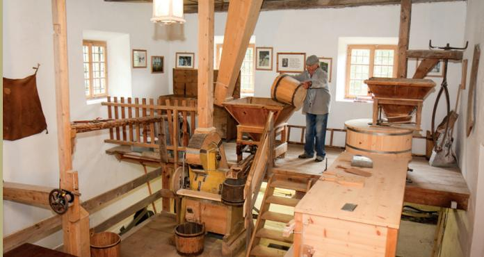
In der „Putze“ (früher Stampfe genannt) wird das Korn zuerst gereinigt und kommt dann in die „Gossete“ zu den Mühlsteinen. Von dort gelangt es zum Holztrichter, der es in die verschiedenen Mehlstärken ausfiltert.
